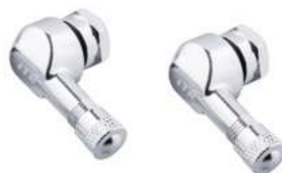
Juego de válvulas universales acodadas en aluminio.
